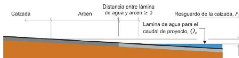
FIGURA 3.2.- RESGUARDO DE LA CALZADA
