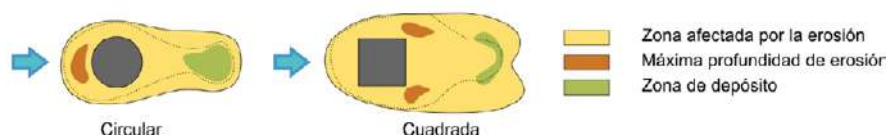
FIGURA 4.5.- COMPONENTES DE LA EROSIÓN CUANDO LAS DIMENSIONES DE LOS OBS-TÁCULOS AL PASO DE LA CORRIENTE SON PEQUEÑAS EN RELACIÓN CON EL CAUCE
